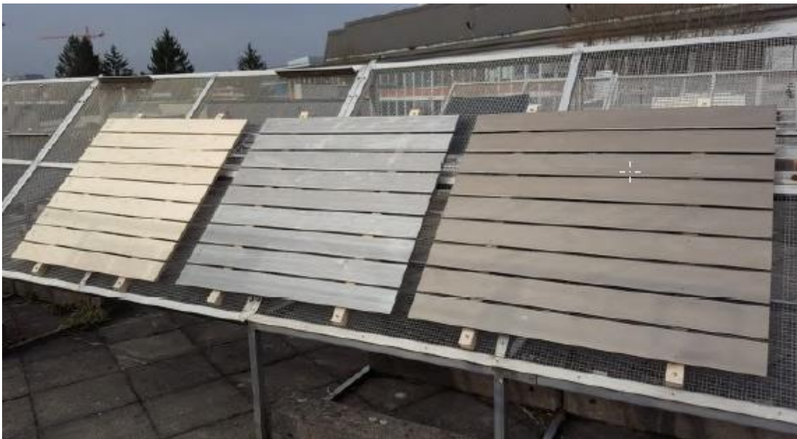
Abbildung 1, die Prüfkörper B, C und D auf dem Bewitterungsplatz bei Beginn der Bewitterung
